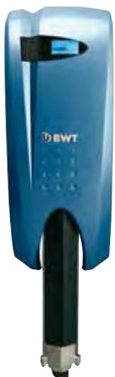
Das Herz des AQA total Energy ist die einzigartige Bipolar-Technologie: Durch präzise abgestimmte Strom- und Spannungsimpulse bilden sich winzige Kalkkristalle. Diese Nanokristalle stabilisieren den im Wasser gelösten Kalk. So bleibt er – genau wie alle anderen Mineralien – im Wasser erhalten, lagert sich aber nicht in Leitungen oder Boilern ab. Eine zusätzliche Funktio-
