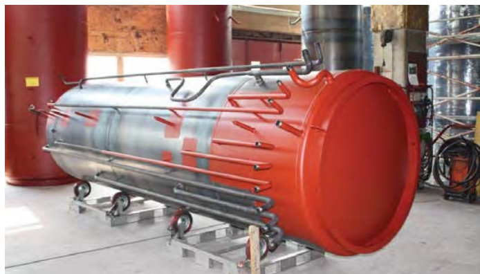
In Arbeit: Solarpeicher mit angeschweisster Verrohrung
