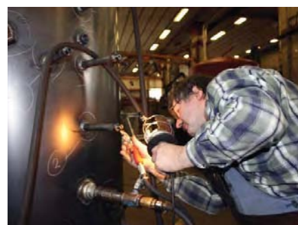
Jeder Speicher wird mit Wasser gefüllt und einer strengen Qualitätskontrolle unterzogen
