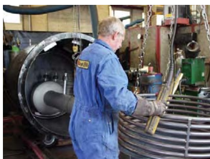
Wärmetauscher, Boiler und Stützen werden angeschweisst
