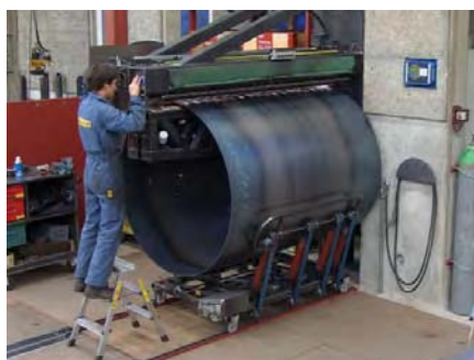
Die Längsschweissnaht wird automatisch ausgeführt
