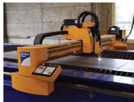
Die Anschlüsse werden vom abgewickelten Blech mit der Plasmaschneidmaschine herausgeschnitten
