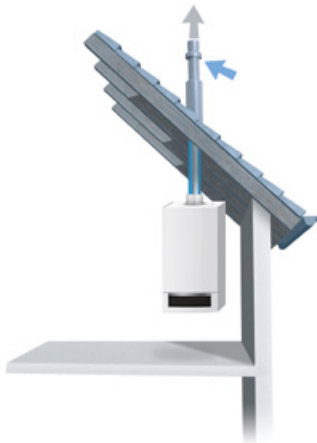
Raumluftunabhängige Aufstellvariante mit Abgasleitung über Dachinstallation
