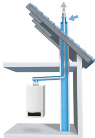
Raumluftunabhängige Aufstellvariante mit eingezogener Kunststoff-Abgasleitung im Schornstein (geeignet zur Luftansaugung über den Ringspalt des Schachtes)
