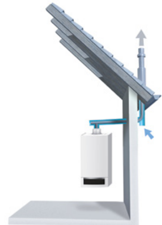
Raumluftunabhängige Aufstellvariante mit Kunststoff-Abgasleitung und Edelstahl-Außenrohr an der Fassade (geeignet zur Luftansaugung über den Ringspalt)
