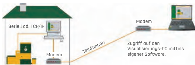
Möglichkeit 1: Visualisierungs-PC in der Nähe der Anlage
